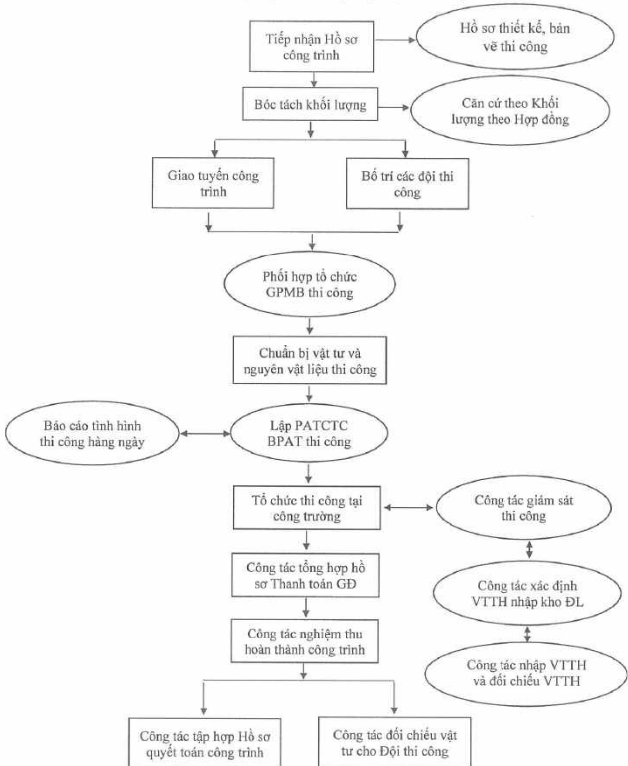
Hình 6. Quy trình thực hiện thi công, xây lắp các công trình điện
